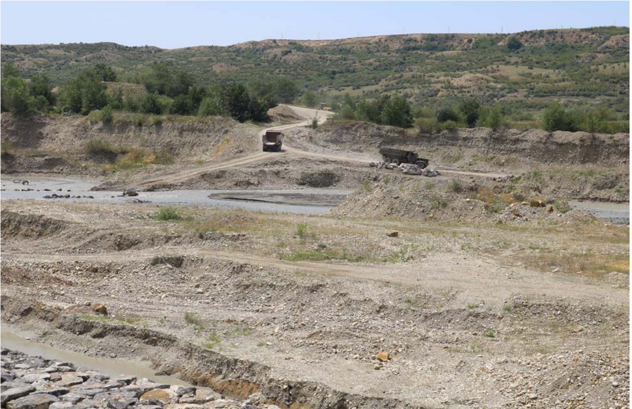
ფოტო 7. ირინა სვანიძე, ივლისი 2021. საკარიერო გზა და ქვიშა-ხრეშის გადაშვიდავი სატვირთო ავტომანქანები მდინარე იორის სანაპიროზე, სოფელ ხაშმთან. ფოტო მწვანე ალტერნატივას არქივიდან.
