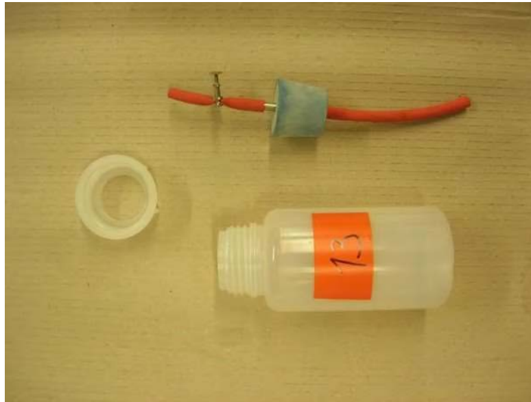
სურათი 35 ქვანახშირის ნიმუშის ასაღები ბოთლი
