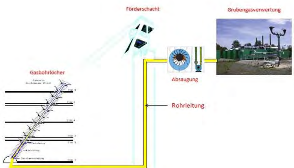
სურათი 19 ბუნებრივი აირის სადრენაჟო სისტემა
